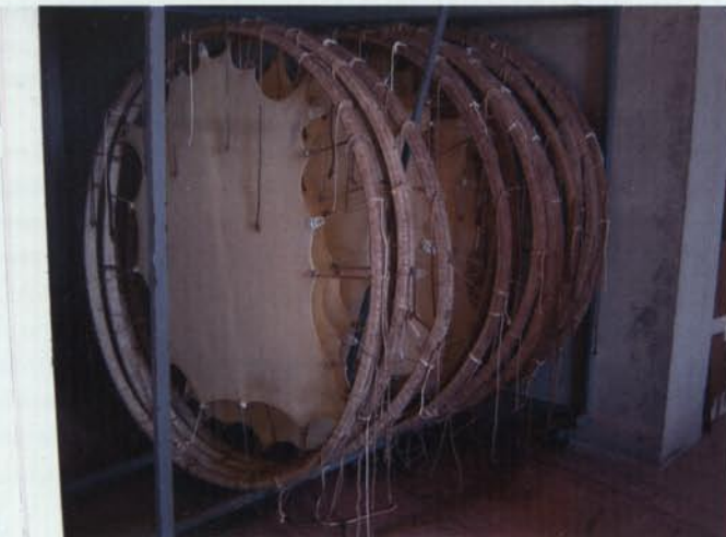
6. Pergamins tensats als cercols durant el procés d'assecatge (Fotografia: Documenta S.C.P.).
