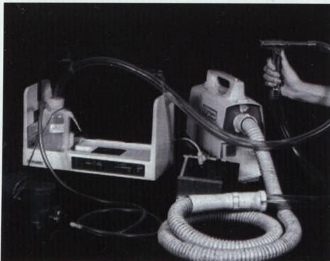
1. Nebulitzador per ultrasons desenvolupat per Michalski (CCI). Imatge obtinguda de S. MICHALSKI, C. DIGNARD, L. VAN HANDEL, D. ARNOLD, 1998, p. 499.
