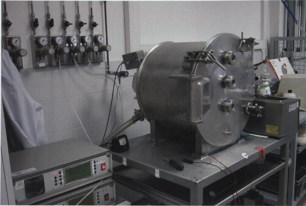
3. Reactor de plasma dissenyat i fabricat a l'Institut Químic de Sarrià.
