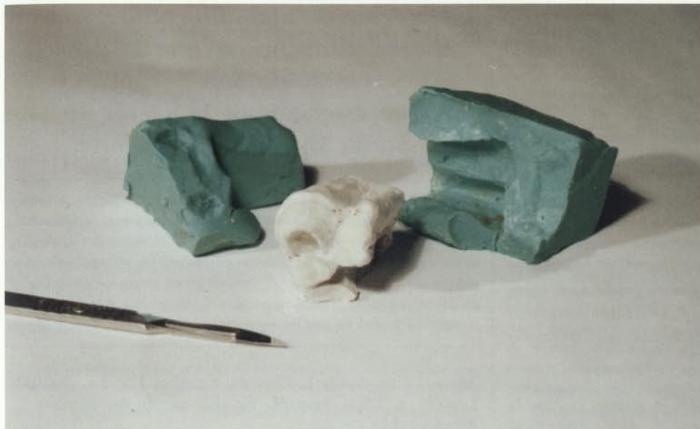
Peça d'escaiola resultant del motlle d'alginat (Fotografia: S. Cano).
