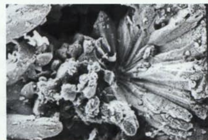
6 b. Disposició radial dels cristalls de calcita. Aquesta fotografia correspon a una imatge de SEM d'una pàtina desenvolupada sobre granit a la catedral de la Seu d'Urgell.
