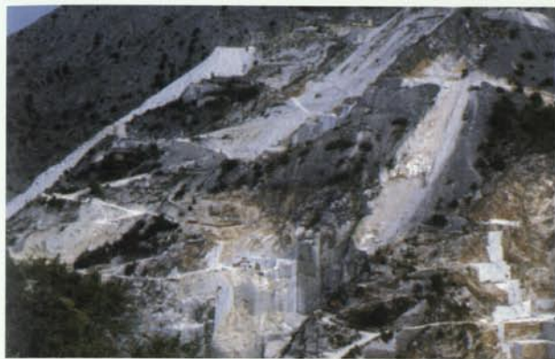
3. Vista general d'un front d'explotació abandonat a una pedrera de marbre de Carrara (Itàlia). S'observa el desenvolupament de diferents tipus de pàtines, especialment una zona amb pàtines ataronjades.
