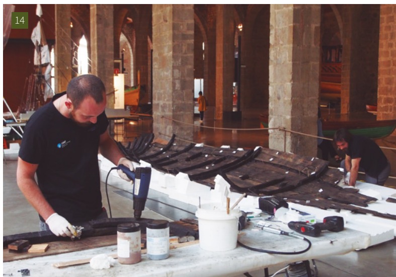
[14] Eliminació de l'excés de PEG amb aire calent, mentre s'avança en la presentació de peces sobre el suport provisional (Fotografia: Albert Vila, Rut Geli i Pol Camps).
