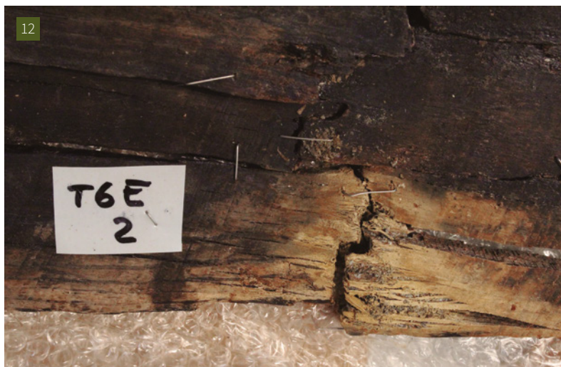
[9] i [10] Taques i cristallitzacions observades l'any 2016 al treure el plàstic de bombolles (Fotografia: MMB).
