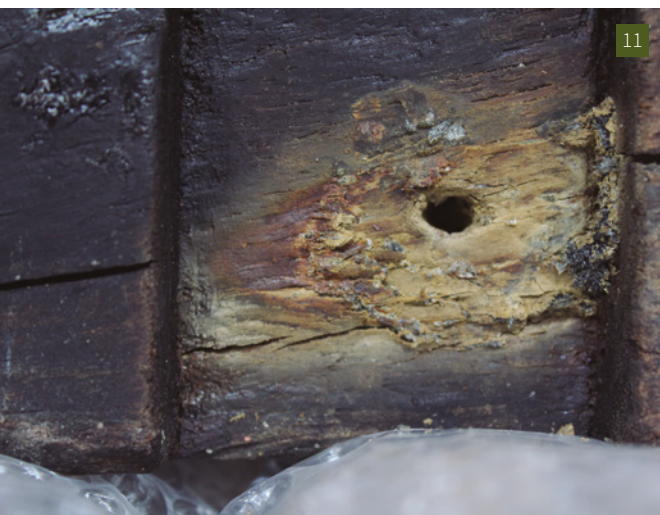
[9] i [10] Taques i cristallitzacions observades l'any 2016 al treure el plàstic de bombolles (Fotografia: MMB).
