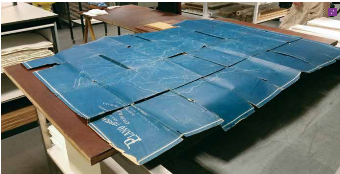
[1 i 2] Fotografies de l'estat inicial del plànol. Es pot observar l'extrema fragilitat del paper causa de l'ús i el plegat per ser guardat. El paper es trencava amb facilitat a les zones de les ruptures a causa de la gran quantitat de petites esquerdes. Un problema afegit eren les pèrdues de suport (Fotografia: Luis Crespo).
