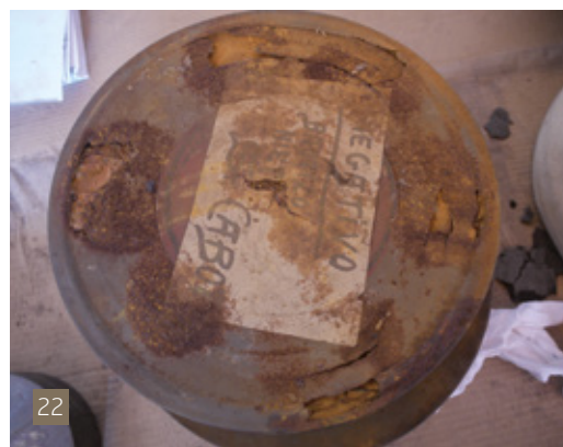
[22]. Llauna degradada per la descomposició dels nitrats (Fotografia: Olga Payan).
