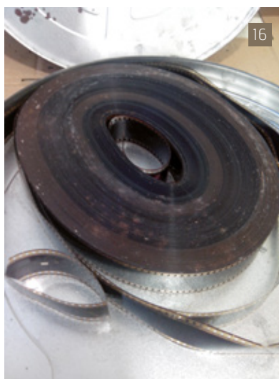
[15] Pel·lícula d'acetat degradada. El color magenta és característic dels sistemes tri-capa.
