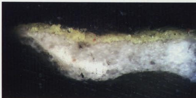
2. Perfil de la mostra on es distingeixen clarament la capa pictòrica groga i la base de preparació blanca inferior (MO) (Fotografia: Patrimoni UB).
