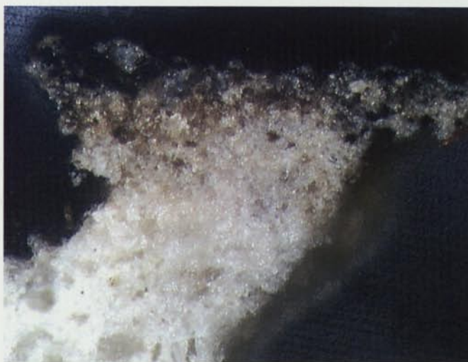
4. Perfil estratigràfic de la mostra negra. A la part superior esquerra de la imatge es percep certa tonalitat blavosa del pigment (MO) (Fotografia: Patrimoni UB).
