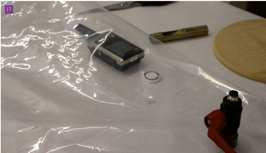
[17] Detall del termohigròmetre i el disc de cotó impregnat, col·locats a l'extrem esquerre de la bossa .
