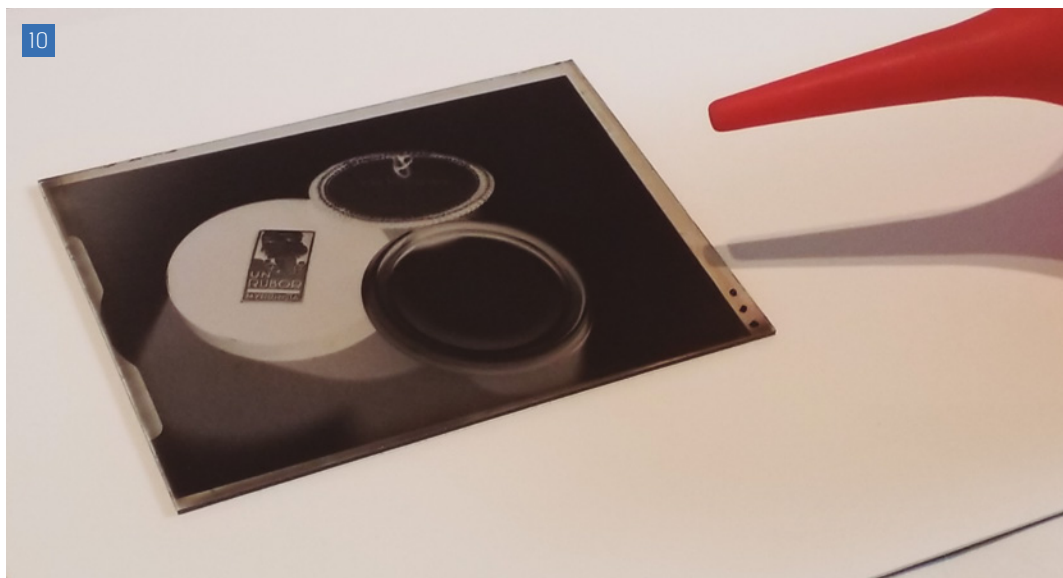
[10] Neteja mecànica d'un negatiu en suport de vidre, en sec i mitjançant pera d'aire.
