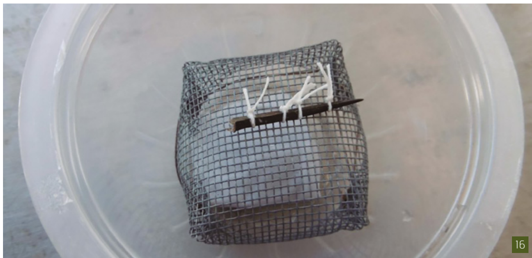
[16] Prova d'assecatge amb consolidació prèvia d'una pua (Fotografia: Irene García Alonso / ARC-Nucléart).
