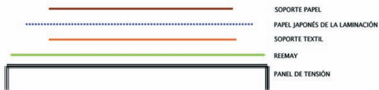
[10] Secció del resultat de l'adhesió dels dos suports amb la laminació intermèdia de protecció, sobre el panell en tensió (Esquema: Clara Bosch Rivas).
