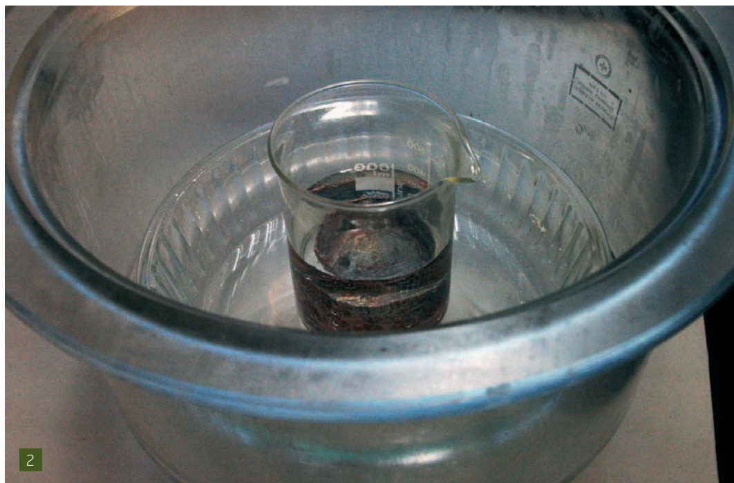
[2] Procés de consolidació per immersió abans de fer el buit (Fotografia: Laia Fernández).
