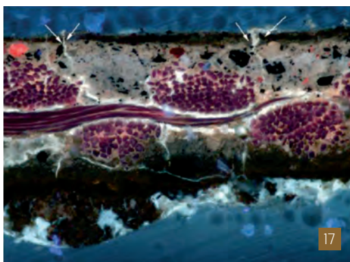
[17] Imatge obtinguda al microscopi òptic amb llum UV de la secció transversal d'una micromostra (objectiu MPlan 20x/040). S'observen les fractures i microclivelles profundes de les capes de la policromia i es pot apreciar la penetració del vernís des de la capa superior (fletxes), així com la fluorescència de les restes d'adhesiu en la part inferior de la imatge (Imatge: Laboratori Arte-Lab).
