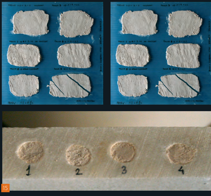
[15] Proves de morter sobre planxes de policarbonat i sobre marbre de Macael (Fotografia: equip tècnic de Restaura).
