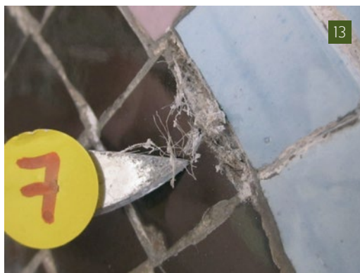
13. Fibres d'espart trobades en el morter de junt, tram C M13 (Fotografia: Àbac).
