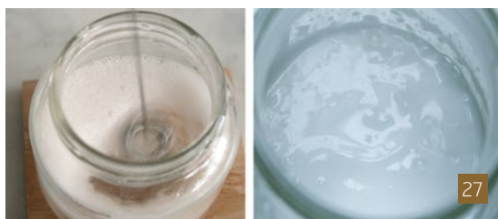
[24] Test d'opacitat, viscositat i humectació. SG4 i gel DMSO (Imatge: Raúl Gámiz Rivas).
