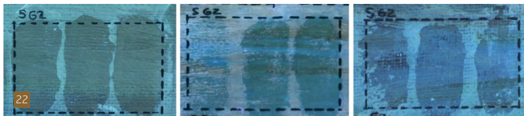
[21] Fluorescència d'una gota de SG1 sobre el vernís i fluorescència dels residus de SG1 abans de l'esbandit. Microscopi digital amb llum UV, 60x (Fotografies: Raúl Gámiz Rivas).
