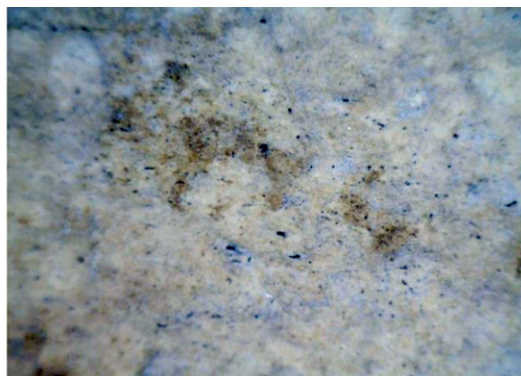
[20] Imatges de microscopi DinoLite (60x). Ceràmica: zona tractada amb aigua (esquerra) en contraposició a la zona tractada amb bacteris (dreta). La zona tractada amb bacteris no té sals visibles a microscopi.
