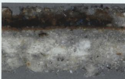
3. Microfotografia de la làmina prima de la mostra del daurat aplicat directament sobre atzurita de la figura anterior. El bol s'ha estès a tota la túnica, incloses les bandes blaves (Fotografia: M. Gómez).
