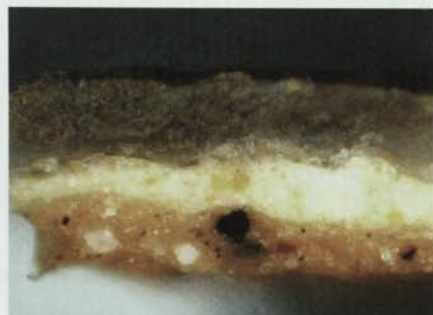
7. Microfotografia de la mostra d'un motiu brocat de la figura anterior. Estany alterat amb vestigis molt escassos d'or, pasta opaca ataronjada del farcit del brocat i "sis" adhesiva que enganxa el brocat al fons de la vestimenta (Fotografia: M. Gómez).
