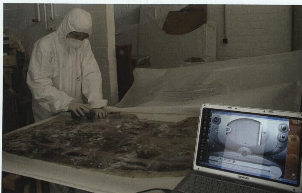
15. Mesures de color amb espectrofotòmetre (Fotografia: Lúdia Balust).
