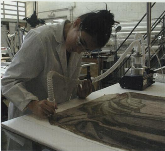
17. Aplicació de funori en el procés de fixació de la capa pictòrica mitjançant un vaporitzador d'ultrasons (Fotografia: Mónica Mora).
