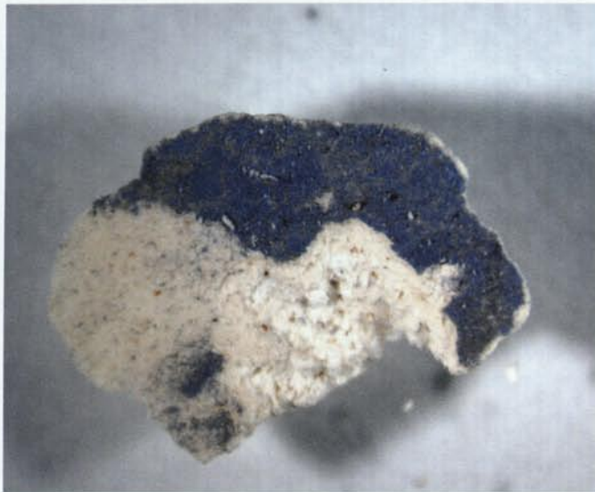
4. Imatge obtinguda amb estereomicroscopi del pigment i capa de preparació de la zona de color blau del mur (Fotografia: Patrimoni UB).
