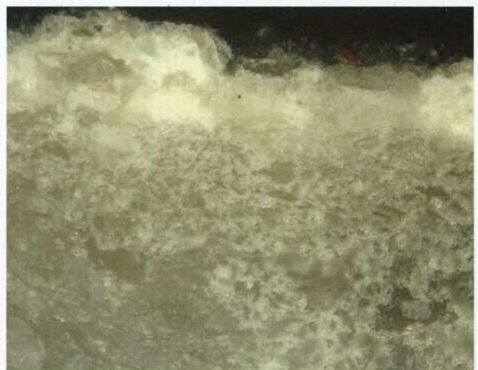
7. Detall de l'estratigrafia de la preparació amb MO (Fotografia: Patrimoni UB).
