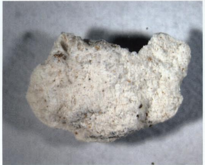
5. Imatge obtinguda amb estereomicroscopi del revers de la mostra on s'aprecia l'arrebossat de preparació (Fotografia: Patrimoni UB).
