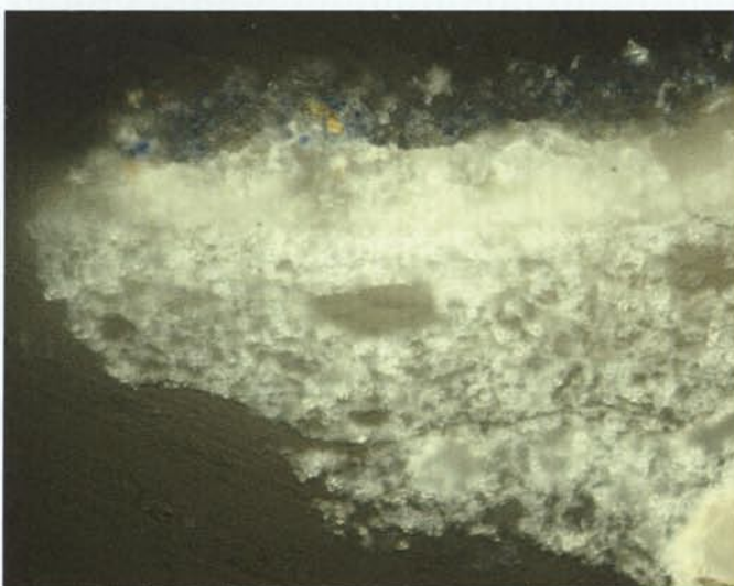
6. Detall de l'estratigrafia de la capa pictòrica amb MO (Fotografia: Patrimoni UB).
