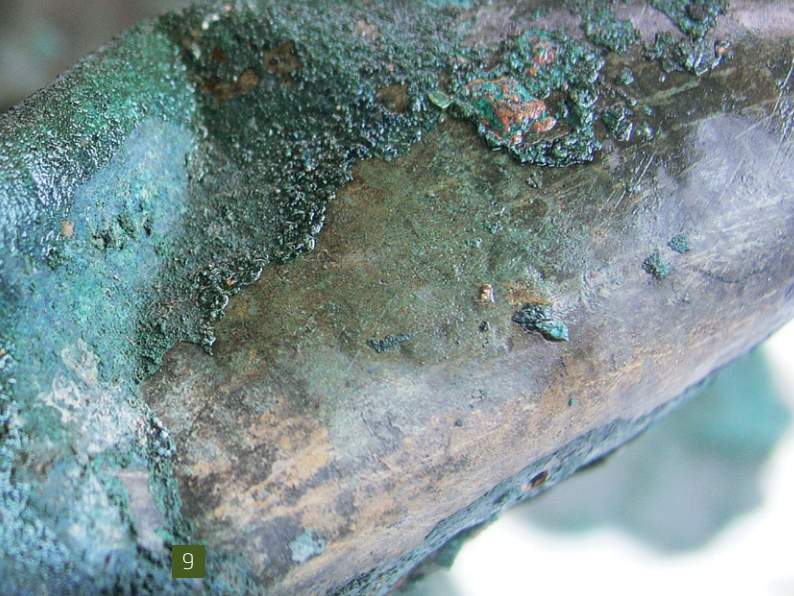
Detall de la capa de productes de corrosió sobre el bronze de la peça T2-30-98-2247-3 i fotografia de detall de la peça T2-30-98-1511 observada amb lupa binocular (Fotografies: Maria Dalmau i Domingo López).
