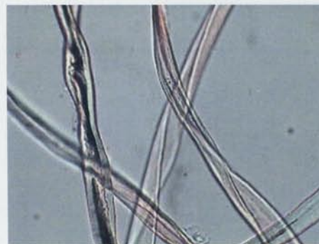
6. Visió de la mostra de paper amb microscopi òptic a 250x. Fibres tenyides amb reactiu Herzberg (Fotografia: Rosa Rocabayera).
