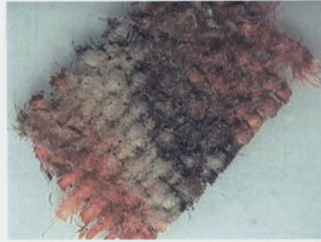
4. Detall dels fils de la mostra de tela observada amb lupa binocular a 100x (Fotografia: Rosa Rocabayera).
