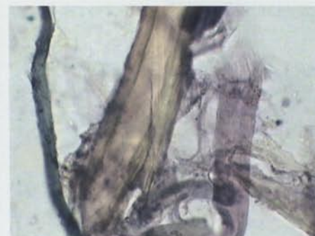
7. Visió de la mostra de paper amb microscopi òptic a 400x. Detall de fibres de fusta i cotó (Fotografia: Rosa Rocabayera).
