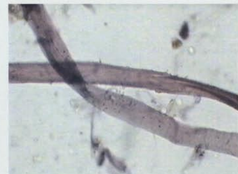
7. Visió de la mostra de paper amb microscopi òptic a 400x. Detall de fibres de fusta i cotó (Fotografia: Rosa Rocabayera).
