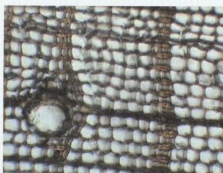
2. Visió de la mostra de fusta amb microscopi òptic a 400x. Tall longitudinal radial (Fotografia: Rosa Rocabayera).
