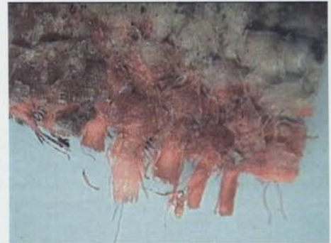
5. Observació de les fibres de cotó de la mostra de tela amb microscopi òptic a 400x (Fotografia: Rosa Rocabayera).
