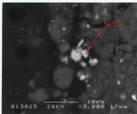
Figura 10: Imatge BSEI-SEM. S'observen unes partícules brillants i denses de pigment o càrrega que tenen una mida variable i són subanguloses.
