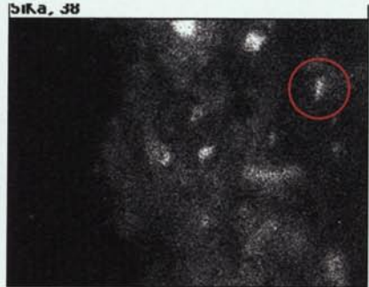
Figura 17: EDX Mapa d'elements químics. La fina capa de policromia coincideix amb la distribució de titani. Això determina que la matriu blanca de la capa de policromia està composta per blanc de titani.
